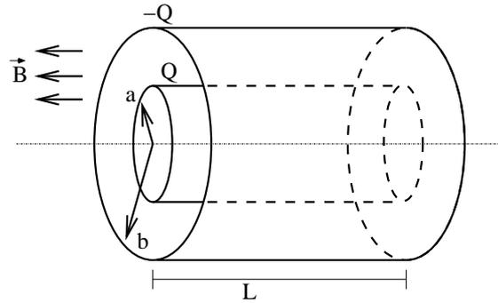
(a) Bestimmen Sie das elektrische Feld  $\vec{E}$  und den Poynting-Vektor  $\vec{S}$  im Inneren des Kondensators.
