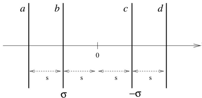
$$\left[ \text{Anschlussbedingung des el. Feldes: } \vec{E}(z_0 + \Delta) - \vec{E}(z_0 - \Delta) = \vec{n} \frac{\sigma(z_0)}{\epsilon_0} \right]$$
